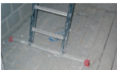
Figuur 7: een stabilisatiebalk verhoogt de zijdelingse stabiliteit
