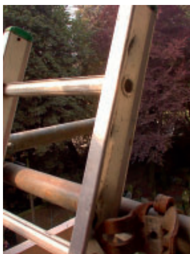
Figuur 3: Een vlak afgewerkte sport met goede antislipseigenschappen
