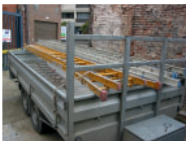
Figuur 18: Bij het transport moeten ladders degelijk worden vastgemaakt
