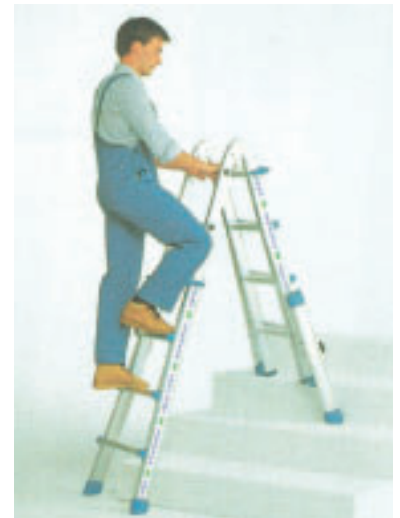
Figuur 8: Het gebruik van hulpstukken om een ladder op te stellen op een plaats met een niveauverschil
